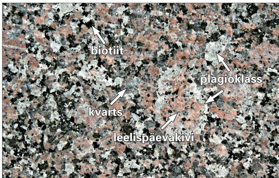
Joonis 15. Viiburgiidne rabakivigraniit, Marjuksenranta, Vehmaa. Värske kivimi pind ülal, murenenud pind all. Murenenud pinnal on kerge märgata põhilisi koostismineraale. Kivim sisaldab rabakivigraniitidele tüüpilist plagioklassiga ümbritsetud kaalium-päevakivi ümaraid ovoide. Geoloogilisel kaardil on rabakivi tumelilla. Foto: O. Eklund
