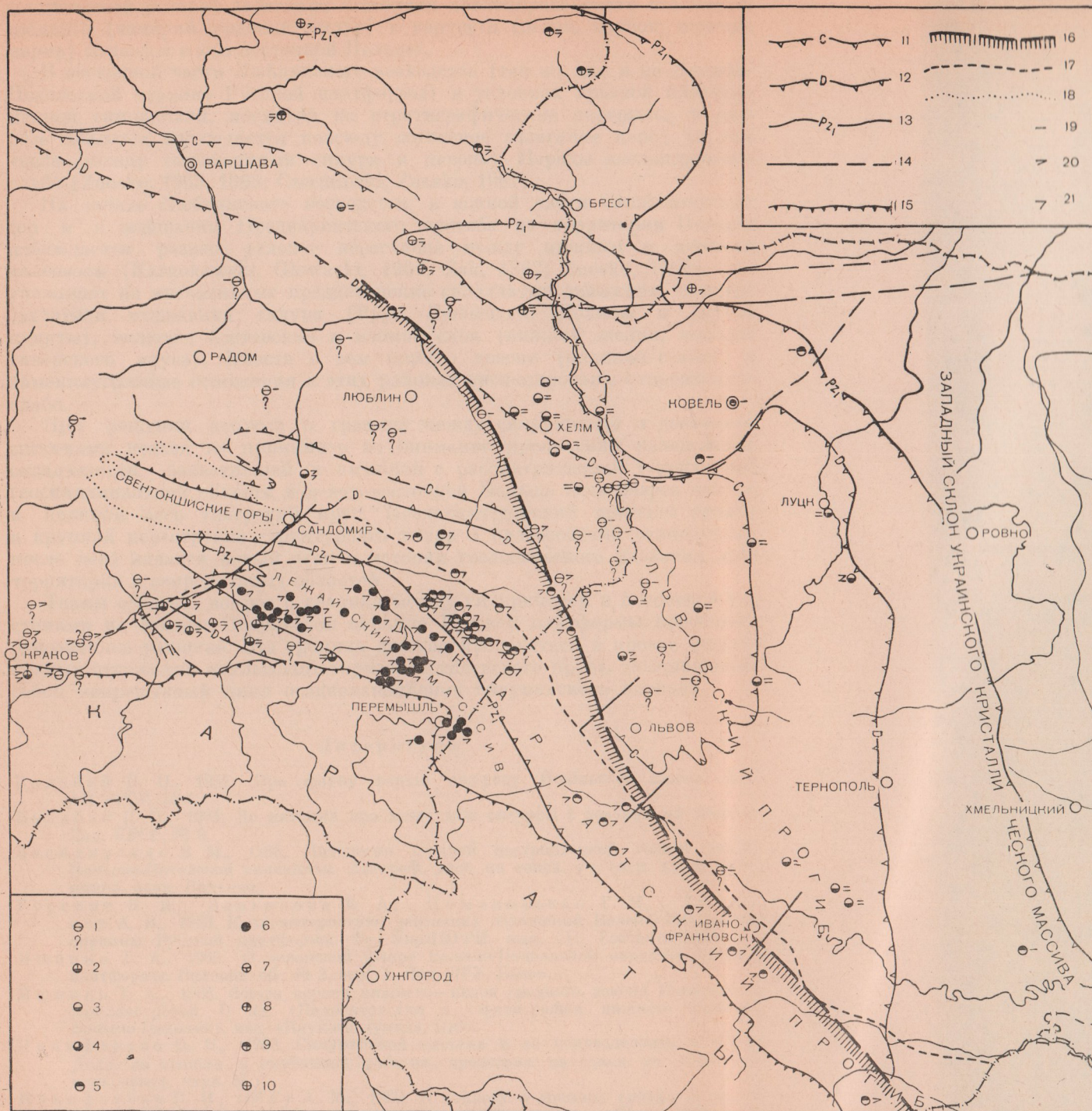
Структурно-геологическая карта юго-восточной Польши и западных областей Украины со снятым покровом мезо-кайнозойских отложений. Составил А. В. Хижняков, 1968 г.
