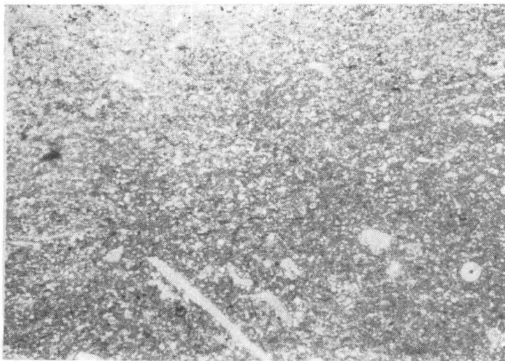
Фиг. 2. Среднеглинистый микро- и тонкокристаллический мелкодетритистый известняк. Скв. Вильянди, глуб. 283,2 м; верхняя часть халликуской пачки. Шлиф, \times 16 .
