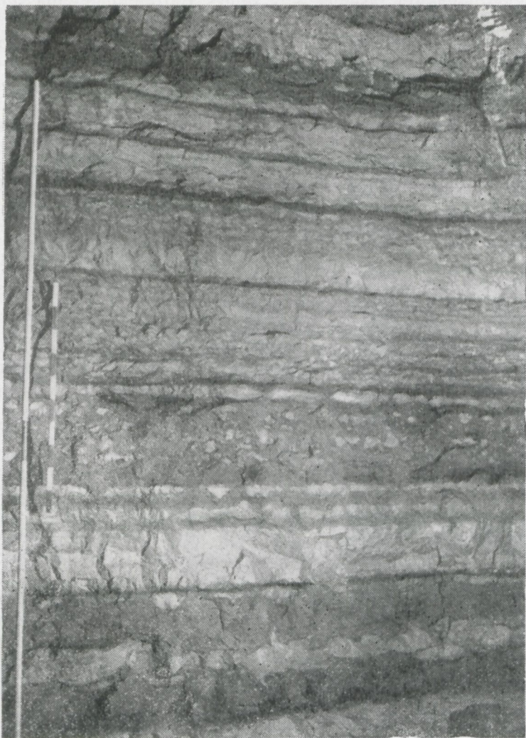
Joon. Põlevkivikihid vahelduvad läbilõikes mitmesuguse paksusega lubjakivikihtidega. Kukersiidi tootsa kihi laekas on meetrise mõõdupuu ülemise otsa lähedal lasuv lubjakivikiht. S. Baukovi foto.
