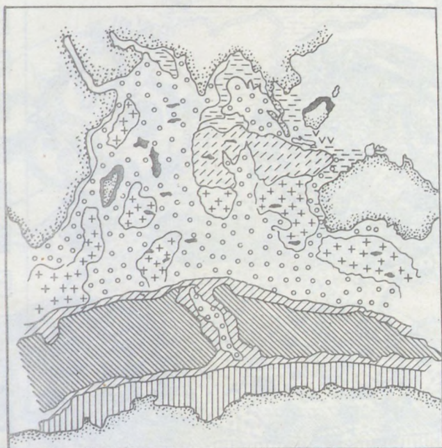
Joon.43. India ookeani setted / 9 /: 1- terrigeensed setted koos jäämägede poolt kantud jämedama purdmaterrjaliga; 2- purd- ja savisetted; 3- karbonaatsed (foraminifeeride ja kokkoliitide) setted; 4- korallide ja vetikate setted; 5-6 - diatoommudad; 7- radiolaar- ja diatoom-radiolaarmudad; 8- punane süvaveeline savi; 9- püroklastiline materjal; 10 - raua-mangaani konkretsioonid.
