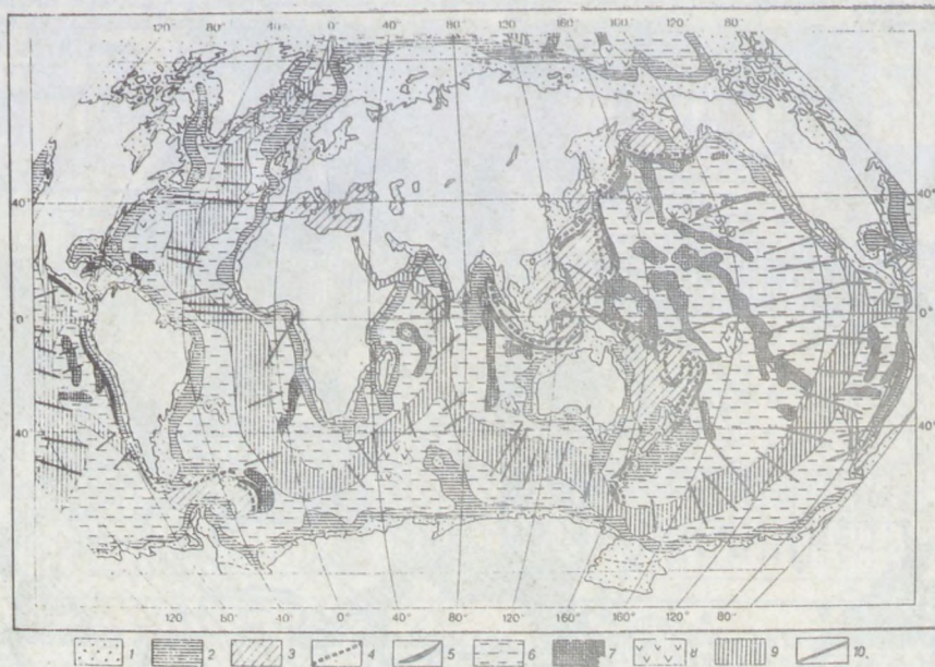
Joon.3. Maailmamere põhja struktuurilis-geomorfoloogiline skeem/ 7 /: 1- šelf; 2- mandrinõlv ja selle jalam; 3- merede süvaveelised nõod; 4- üleminekuvalad, saarkaared; 5- süvikud; 6- ookeani põhja nõod; 7- ookeani põhja mäed ja mäeahelikud; 8- ookeani põhja kõrgustikud; 9- ookeani keskahelikud; 10- murrangud.
