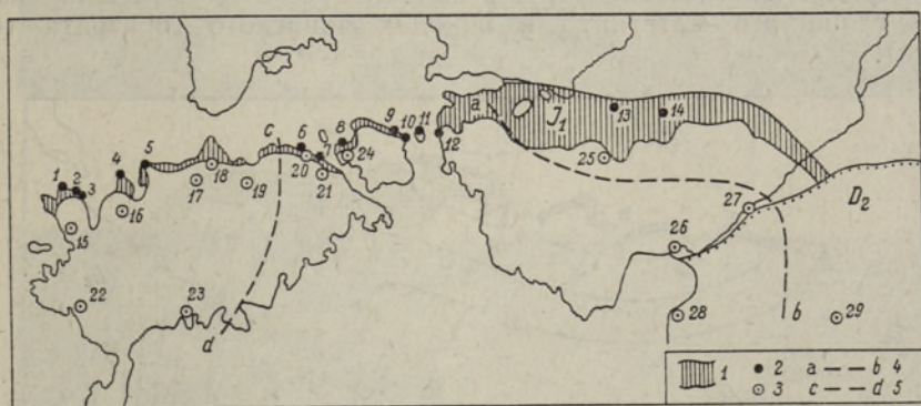
Рис. 1. Выход, наиболее важные обнажения и буровые скважины яаниского горизонта. 1 — выход горизонта; 2 — обнажение; 3 — буровая скважина; 4 — предполагаемая граница между карбонатной (на востоке) и глинистой (на западе) литофациями адавереского горизонта; 5 — граница максимального распространения ниназеской пачки ( J_1N ).
