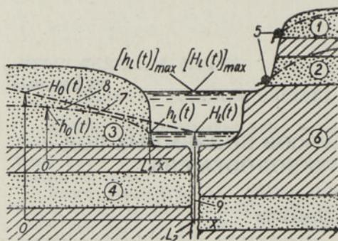
Составляющие подземного питания реки в принятых для расчета системах координат. 1 — водоносный горизонт, гидравлически не связанный с рекой, со свободной поверхностью; 2 — то же с напорной поверхностью; 3 — водоносный горизонт, гидравлически связанный с рекой, со свободной поверхностью; 4 — то же с напорной водоупорные породы; 7, 8 — соответственно напорная и свободная поверхности подземных вод; 9 — тектоническая трещина.
