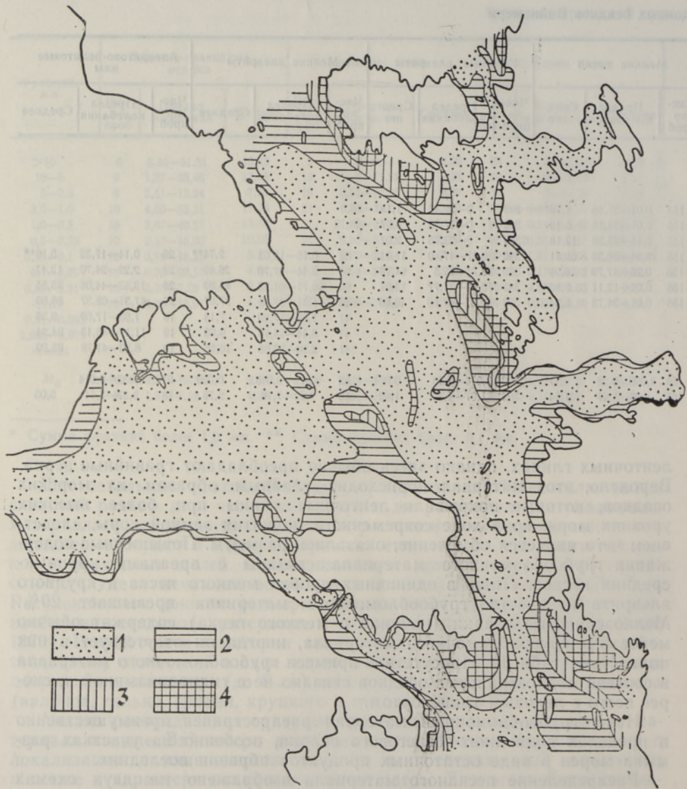
Рис. 1. Схема распространения грубообломочного материала в осадках Вайнамери. 1 — менее 10%, 2 — 10—25%, 3 — 25—50%, 4 — более 50%.
