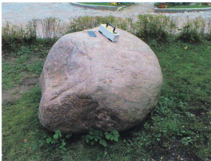
Joonis 3.12. Migmatiit-graniidi rahn Paldiski raudteejaama õuel. Pakri – E mõõdab kiirgust \alpha –, \beta – ja \gamma – kiirguse mõõtmise režiimil (filtrid on avatud).
