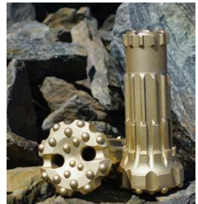
Suruõhuga puurimisel kasutatav puurkroon.
