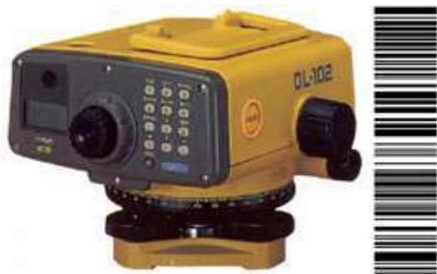
Digitaalnivelliir Topcon DL-102 ja vastava koodustriga latt.
