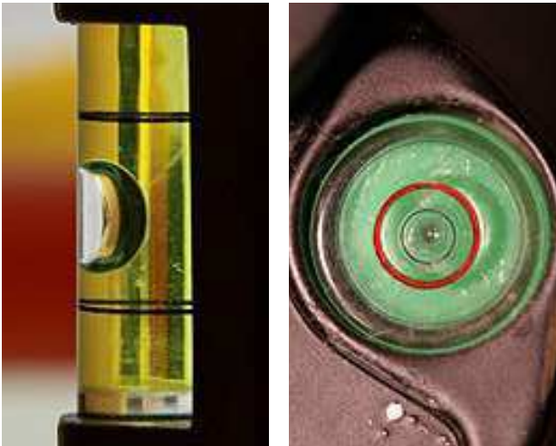
Silindriline (vasakul) ja ümarvesilood (paremal). Allikas: https://en.wikipedia.org/wiki/Spirit_level .
