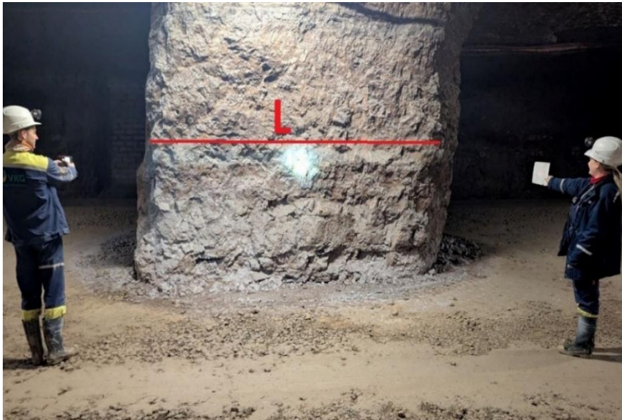
Joonis 12. Tervikute külgi mõõdetakse nurgast nurka.
