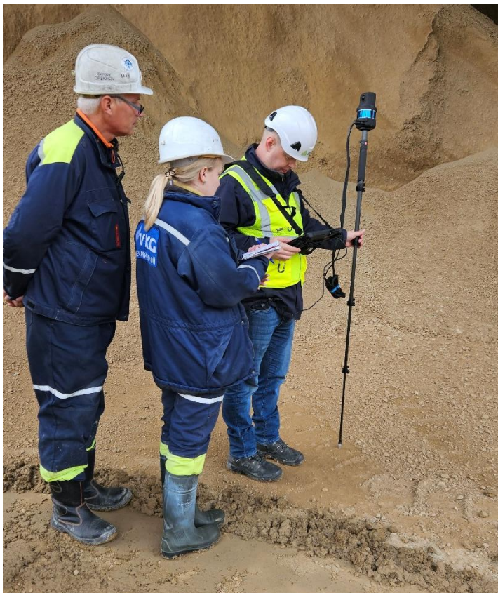
Joonis 18. Laserskanner Heron Lite katsetamine.
