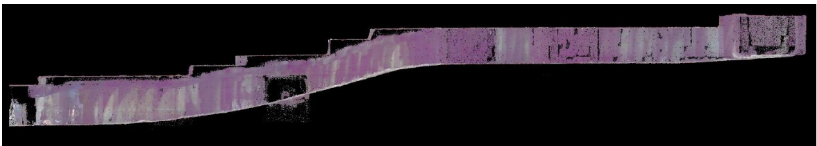
Joonis 34. Stonex X70GO Slam külgvaade puhastatud punktipilvest. Punktide värvus põhineb RGB-värviantmetel.
