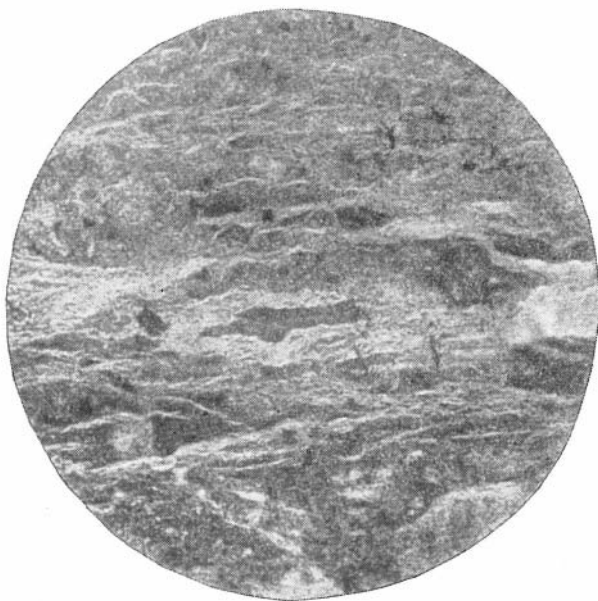
Рис. 23. Гипсодоломит. Тонкие прожилки (светлое) пронизывают всю породу вдоль слоистости. Верхний силур. Увел. 25, николи ||
