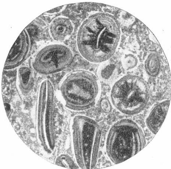
Рис. 20. Известняк оолитовый, фосфатизированный. Фосфат (темное) слагает внутренние части оолитов. Криволуцкий ярус. Увел. 25, николи ||
