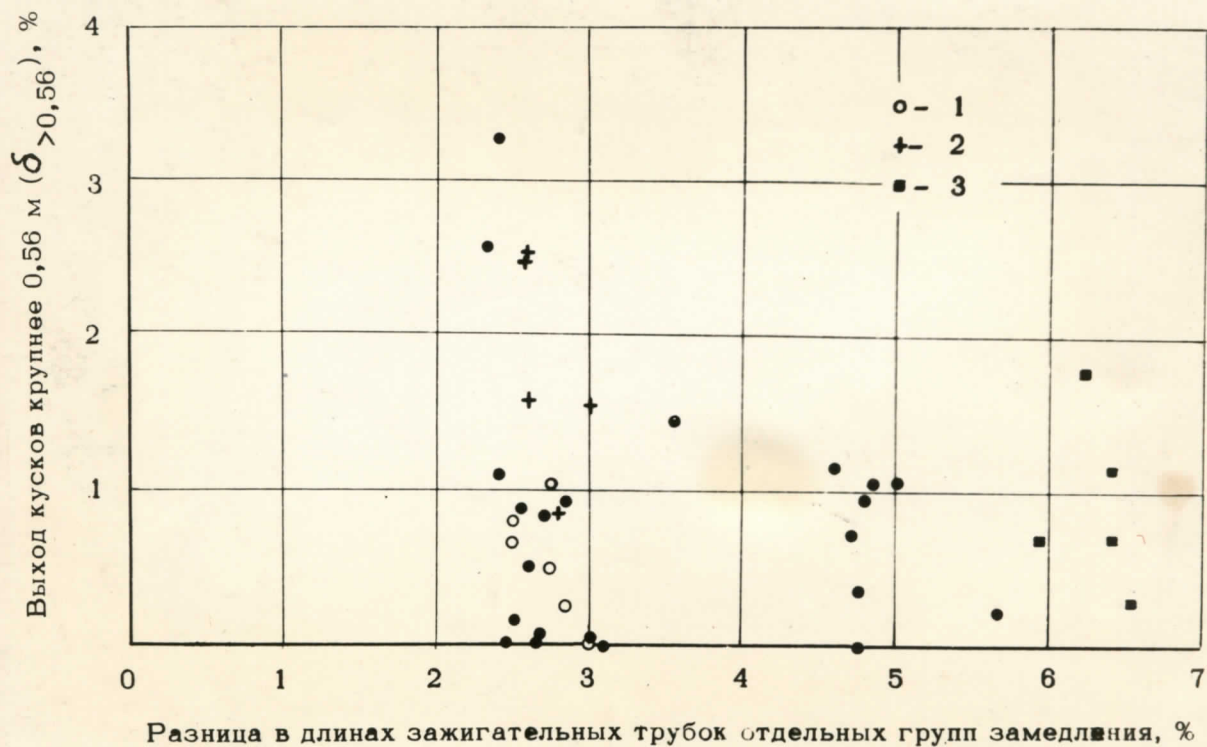
Рис.19. Уменьшение выхода кусков класса крупнее 0,56 м в зависимости от разницы в длинах зажигательных трубок отдельных групп замедления. 1 - первая серия; 2- вторая серия опытов; 3 - машинный вруб (1х серия).
