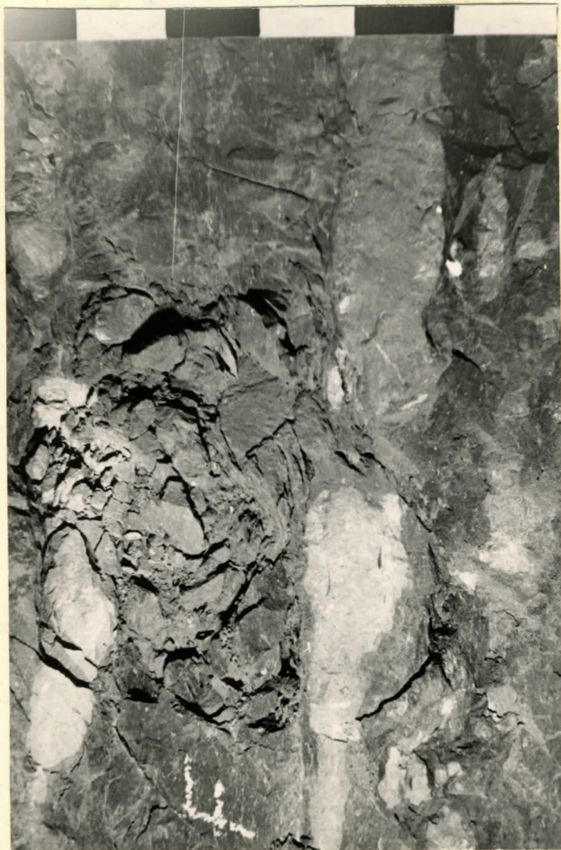
Рис. 17. Вид на зону мелкого проблнения вокруг заряда в пачке Г. Деление мерной рейки за 5 см.
