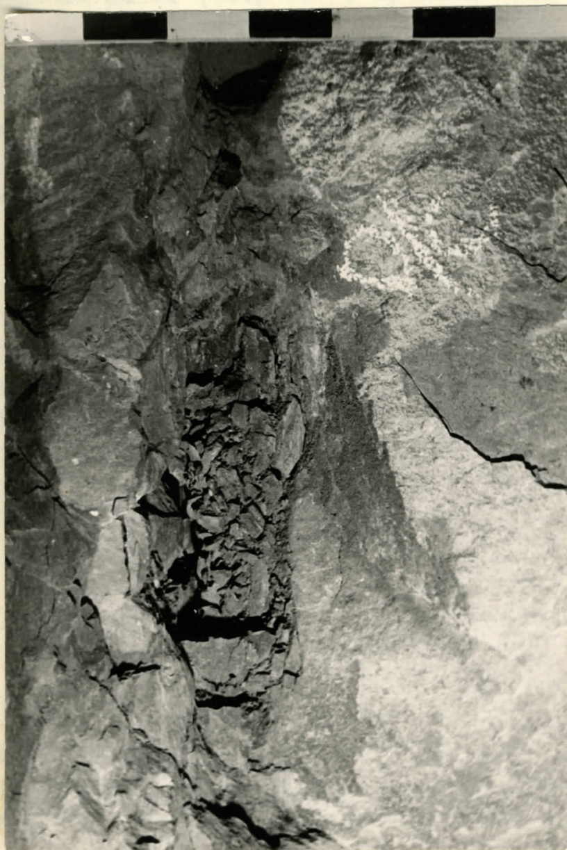
Рис. 9. Вид зоны мелкого дробления в пачке D. Деление мерной рейки за 5 см.
