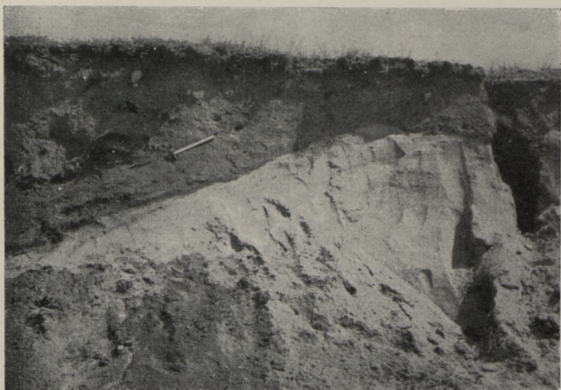
Фиг. 4. Залегание серой морены на красно-бурой морене (молоток на границе обеих морен), а последней — на водно-ледниковых мелкозернистых слоистых песках в карьере Уула, западнее ТЭЦ Улила.
