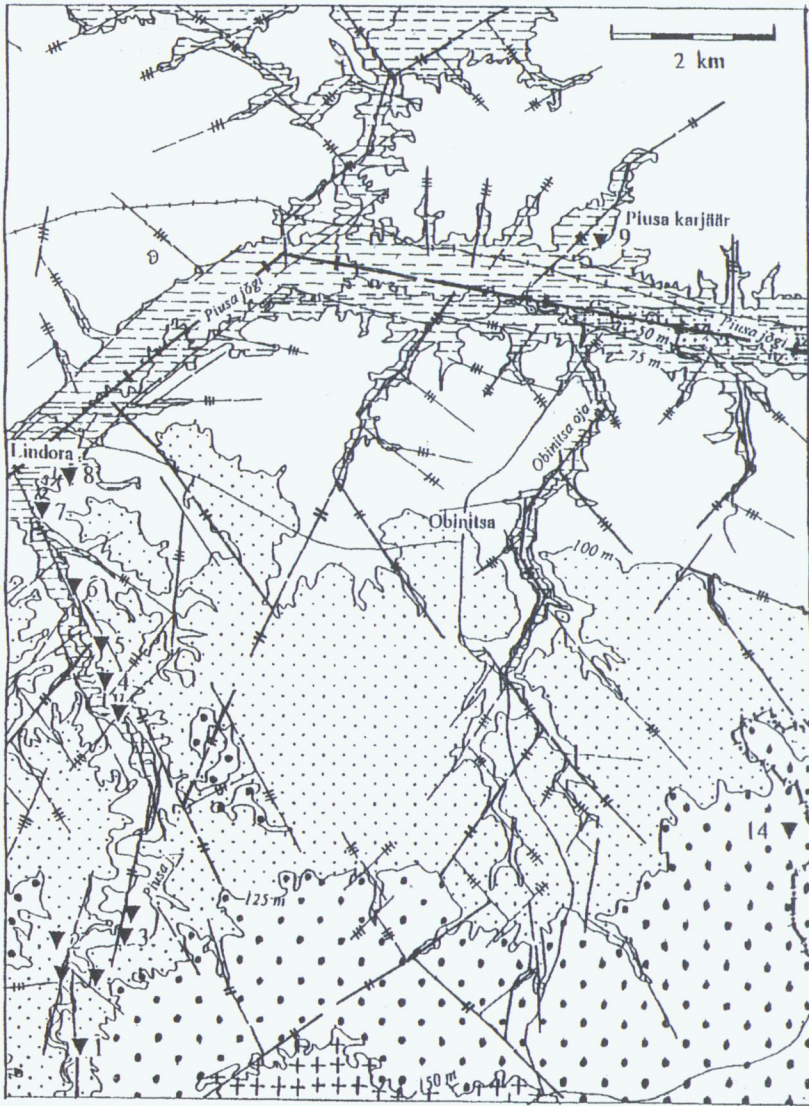
Joonis 1. Piusa jõe keskjooksu reljeefi ja lineamentide skemaatiline kaart. Reljeef on antud 25-meetriliste kõrgusvaheliste astangutena. Joontega on näidatud reljeefi lineamid. Ühe ristkriipsuga on märgitud I suurusjärgu tektooniline rike (Võru-Pihkva osaliselt mattunud ürgorg), kahe ristkriipsuga - II järgu rebendrikked (lõheliste kivimite vööndid), kolme ristkriipsuga - III järgu ja väiksemad tektoonilised rikked. Numbritega on kaardil näidatud lõhede mõõtmise kohad: 1 - Make müür, 2 - Savioja, Kurja ja Metssea müürid, 3 - Kalmetu müür, 4 - Nakri ja Härma Keldrimüür, 5 - Kõlksniidu müür, 6 - Suure ja Väikese Hunni müürid, Valgma müür, 7 - Porgona müür, 8 - Tammemüüri mäed, 9 - Piusa karjäär, 14 - Tiirhanna karjäär.
