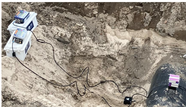
Joonis 10 Mini supergraph II seismomeetrid (Vao V, 12.03.2025)
