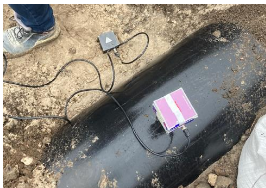
Joonis 11 Seismograafide paigutus ( Väo V, 05.03.2025)
