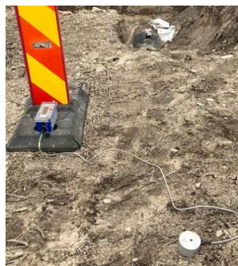
Joonis 12 Seismograaf pinnasel (Väo V, 12.03.2025)
