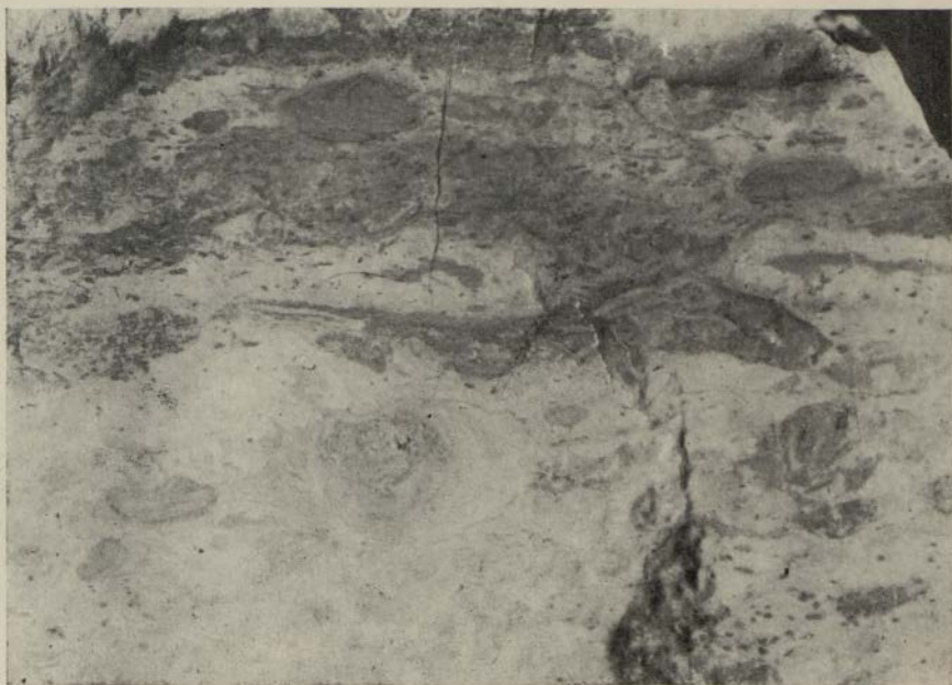
Фиг. 2. Водорослевый доломитовый (маазинранглаский) известняк. Пришлифовка, натуральная величина.
